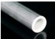
Втулка предназначена для механической защиты проводников или кабеля, которые выходят из стальной трубы. Перед установкой кабеля втулка вставляется в нужный конец трубы.
