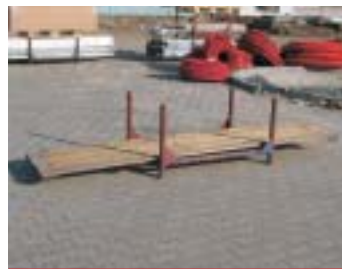
IP4 - деревянная подкладка (+ IP1)
