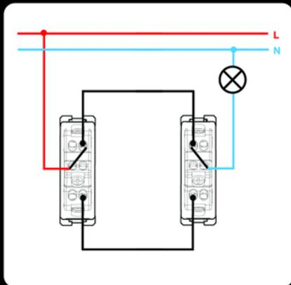
Выключатель проходной (переключатель)
