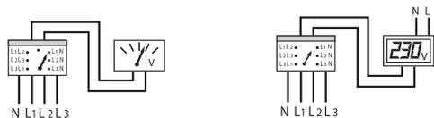
Трехфазный с использованием 4-позиционного переключателя для вольтметра для измерений фаза-фаза
