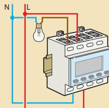
Время замыкания и размыкания выходного контакта рассчитывается исходя из даты требуемого включения/отключения и географических координат места эксплуатации
