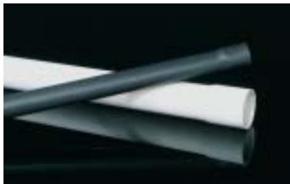
Универсальные защитные трубы используются для монтажа в жилых и производственных помещениях с повышенными требованиями к безопасности людей и оборудования (больницы, школы и т.д.). Пригодны для монтажа на и в огнеопасный материал всех степеней горючести. Трубы черного цвета (FA) устойчивы к ультрафиолетовому излучению (УФ). Можно устанавливать в помещениях со взрывоопасной средой Зона 2.
