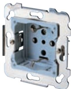
Новый тип механизмов розеток со степенью защиты IP2 со снятым обрамлением. Новые контакты Stai с двойным изгибом (принцип английской булавки) обеспечивают надежную работу на протяжении всего периода эксплуатации, независимо от количества включений. Двойные туннельные клеммы позволяют соединять розетки между собой. Клеммы оснащены винтами для быстрой фиксации и специально спроектированными пластинами, обеспечивающими максимальную площадь контакта.
