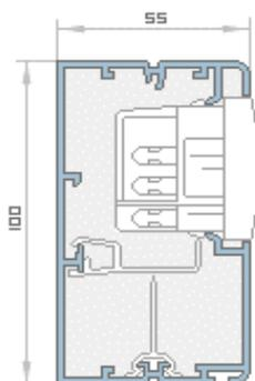
C'est le boîtier idéal lorsque l'on désire installer une alimentation mixte courants forts/courants faibles dans le même boîtier.
