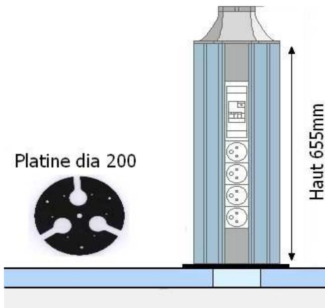
Colonnettes triple-face CODI Delta C en aluminium thermolaqué, pour plancher technique.
