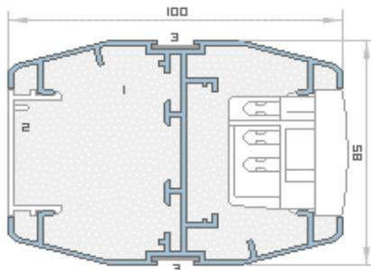
1. Profilé en H permettant la répartition d'appareillages à clipage direct sur les faces A et B. Finition aluminium anodisé naturel, thermolaquage RAL sur demande.
