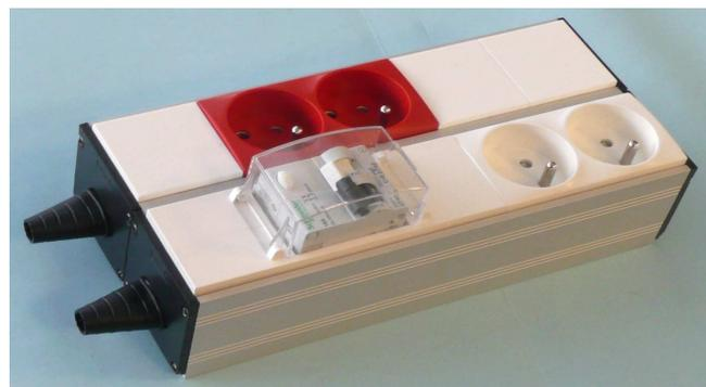
Boîtier double, c'est le plus grand des boîtiers de la série 53. Malgré son volume, il reste compact et discret grâce à son design bien étudié. Les circuits courants forts et courants faibles sont répartis dans deux compartiments séparés. Chaque extrémité du boîtier est équipée de deux embouts (un pour chaque compartiment) en ABS noir, éventuellement en aluminium anodisé. La maintenance est facilitée grâce à cet accès pratique à chacun des circuits électriques.
