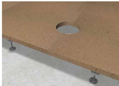
Einbauöffnung mit einem Durchmesser von 306 mm (Toleranz + 1 mm) in Hohlraum- oder Doppelboden herstellen.
