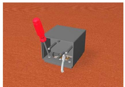
Zapfsäule auf den Sockel aufsetzen und mit vier Schrauben M4 x 12 mm befestigen.
