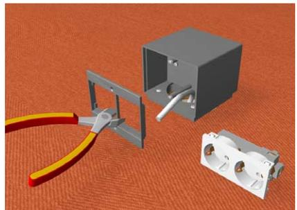
Bei Verwendung von 2-fach Schutzkontakt-Steckdosen muss der Mittelsteg der Installationswand mit einem Seitenschneider entfernt werden.
