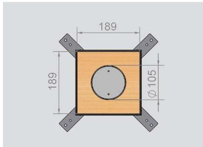
**Außenabmessung:** 199 mm x 199 mm
