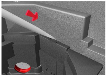
Den Schraubendreher in die Perforation schräg einführen und durch eine Drehbewegung nach oben die Rastnase des Gerätebechers von der Versorgungseinheit lösen.
