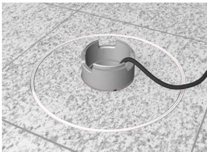
Kassettendeckel wieder einsetzen und Anschlussleitung in einer der drei Aussparungen des Tubus-Leitungsauslasses einlegen.
