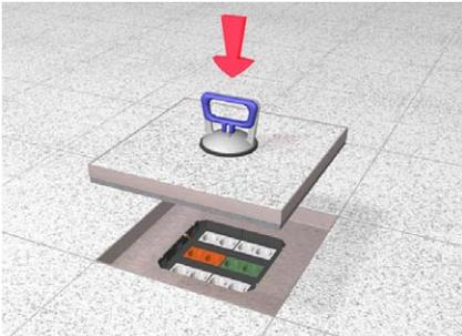
Nach ausreichender Aushärtung des Estrichs und des Bodenbelages den Kassettendeckel mit Hilfe eines Saughebers (z.B. WSH 30) in den Kassettenrahmen einsetzen.
