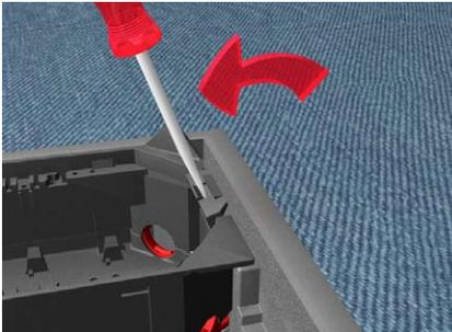
Lasche des Gerätebechers mit Hilfe des Schraubendrehers nach innen biegen.
