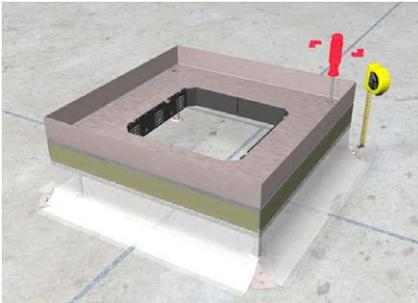
Zur Montage wird der Winkelrahmen mit dem aufgeschraubten Kassettenrahmen auf der Rohdecke aufgestellt und mittels der Nivellierstift auf die benötigte Aufbauhöhe ausgerichtet.
