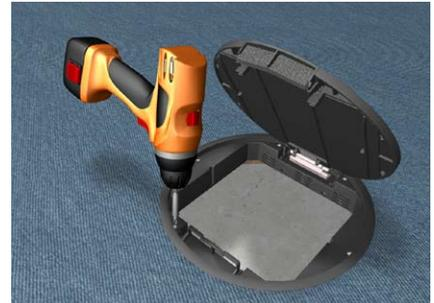
Innenliegende Schrauben der Befestigungssets über Kreuz andrehen. (Kreuzschlitz H2)
