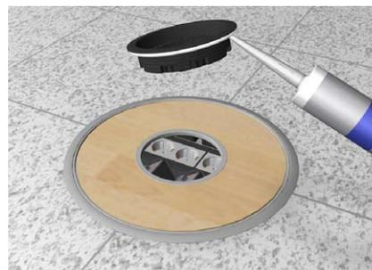
Bei der Versorgungseinheit VAN R12 DK3TTH muss nach dem Einkleben des Bodenbelages die untere Fläche des Belagrahmens vom Polyamid-Tubus mit geeignetem Dichtungsmaterial versehen werden.
