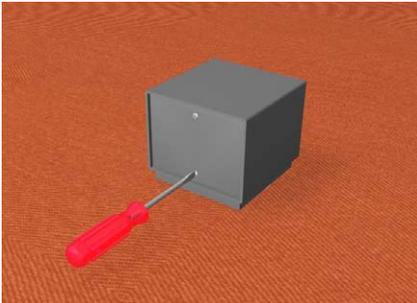
Blindplatte mit zwei Schrauben in der Zapfsäule befestigen.
