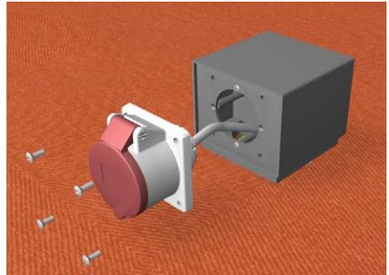
Kabel durch die Installationswand und den Gummi (Im Lieferumfang der CEE Steckdose) führen. Installationswand mit zwei Schrauben in der Zapfsäule befestigen. Kabel an CEE anschließen und CEE mit 4 Schrauben M4 x 16 auf der Installationswand befestigen.
