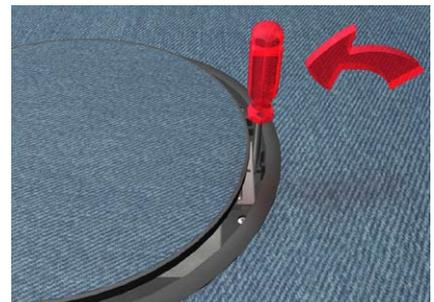
Flachschraubendreher neben der 4 mm Bohrung zwischen Scharnier und Rastnase einstecken. Druck auf Schraubendreher ausüben, diesen gleichzeitig in Richtung Deckelklappe schwenken und somit Rastnase entriegeln.
