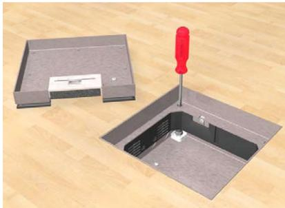
Über vier Nivellierstifte die Kassette auf die gewünschte Höhe ausrichten. Kassettenrahmen sollte bündig mit Oberkante Fertigfußboden abschließen.
