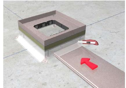
Folien-Estrichschalung in Höhe und Breite des Kanals einschneiden. Folienlasche anheben und Kanal ca. 40 mm unter den Kassettenrahmen einschieben.
