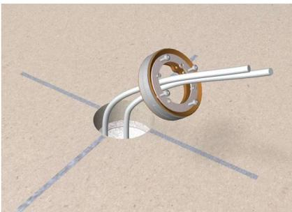
Kabel und Leitungen aus Unterflurkanal durch den Anbohrauslass / Klemmring S080 KK (separat bestellen) führen, so dass die Schraubenköpfe oben sind.
