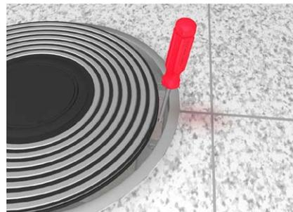
Schraubendreher durch Langloch im Scharnierblech stecken, bis Widerstand spürbar ist. Druck auf Schraubendreher ausüben, diesen gleichzeitig in Richtung Deckelklappe schwenken. Bewegung löst mit leichtem Ruck die Verrastung.
