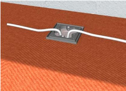
Kabel und Leitungen aus dem Kanal durch die Montageöffnung und den Sockel führen.
