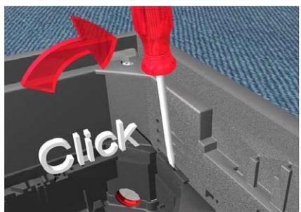
Die Lasche des Gerätebechers mit Hilfe des Schraubendrehers in der gewünschte Rasthöhe einrasten. Die Rastnase muss hörbar einrasten.
