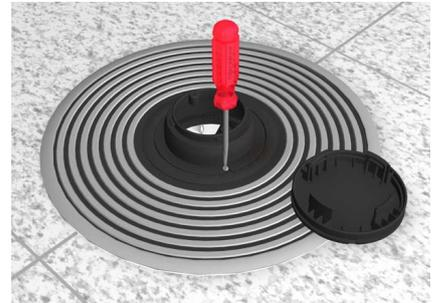
Mit zwei Schrauben, die im Tubusdeckel eingeklipst sind, das Tubus-Mittelteil am Deckel der Versorgungseinheit festschrauben. Somit ist der Tubus gegen seitliche Kräfte geschützt und bleibt in seiner Position.
