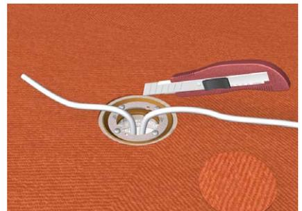
Nach Verlegung des Bodenbelages Bohrlöcher mit einem Cuttermesser freischneiden.
