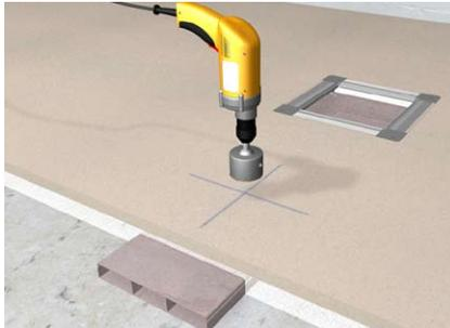
Estrich mit Widia-Bohrlocke bis auf darunterliegenden Unterflurkanal anbohren.
