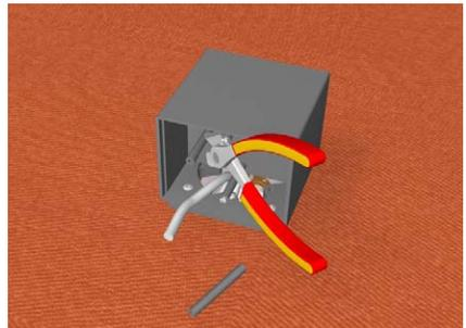
Die zwei äußeren Einschraubzapfen so dicht wie möglich an der Rückwand mittels Seitenschneider oder Kneifzange abtrennen.
