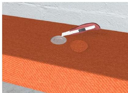
Nach Verlegung des Bodenbelages die Montageöffnung vom darüberliegenden Bodenbelag freischneiden.
