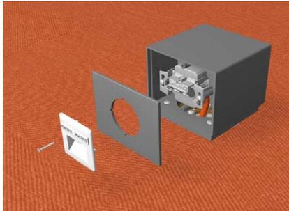
Kabel am Installationsgerät anschließen und in der Zapfsäule mit zwei Schrauben befestigen. Installationswand einsetzen und die Zentralplatte des Installationsgerätes aufschrauben.
