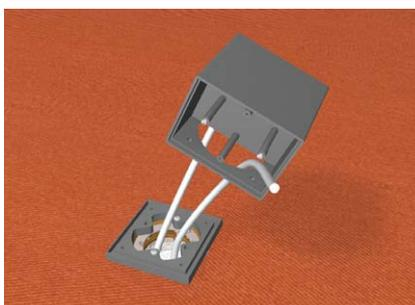
Kabel von unten durch die Zapfsäule führen (bitte auf Verteilung der Installationsplätze und Spannungsarten achten) und bei Zapfsäule mit 4- oder 8-Installationsfeldern die Trennwände einschieben.
