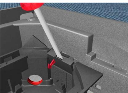
Die Lasche des Gerätebechers mit Hilfe des Schraubendrehers nach innen kippen und somit aus der Perforation der Versorgungseinheit herausziehen.
