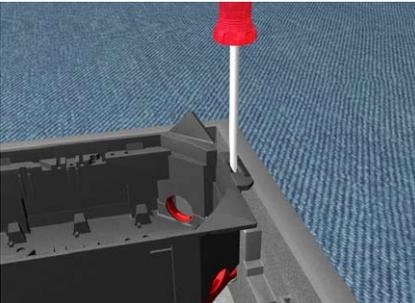
Schraubendreher in die Öffnung der Lasche stecken. Somit kann die Lasche des Gerätebechers optimal geführt werden.
