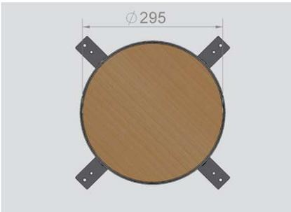
**Außenabmessung:** Ø 305 mm
