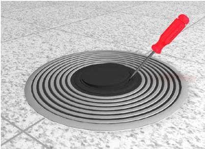
Beim VAN mit Polyamid-Tubus mit einem Schraubendreher nacheinander in die zwei vorgesehenen Perforierungen stecken und durch eine Hebelbewegung den Deckel nach oben herausdrücken.
