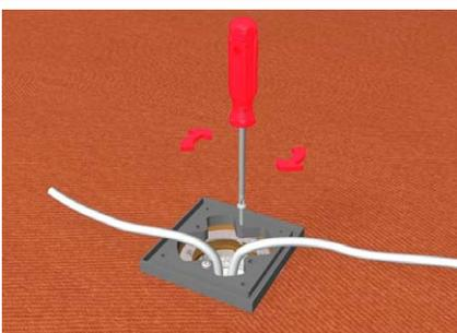
Sockel der Zapfsäule mit zwei Schrauben M4 x 40 mm im Anbohrauslass / Klemmring befestigen.
