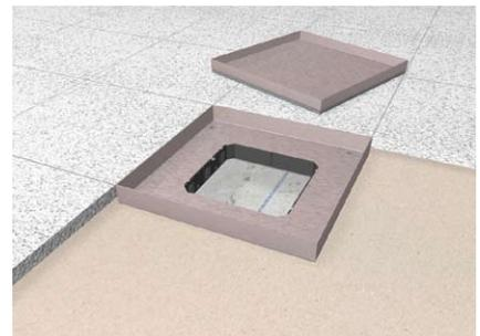
Estrich und Bodenbelag mit einer entsprechenden Dehnungsfuge an den Kassettenrahmen anarbeiten, dabei unbedingt auf Sauberkeit im Kassettenbereich achten.
