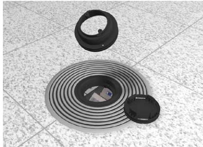
Das Mittelteil des Tubus-Leitungsauslasses mit der Hand herausnehmen und um 180° gedreht wieder aufstecken. Deckel der Versorgungseinheit kann nun geöffnet werden, indem mit der Hand in die Öffnung gegriffen und nach oben gezogen wird.
