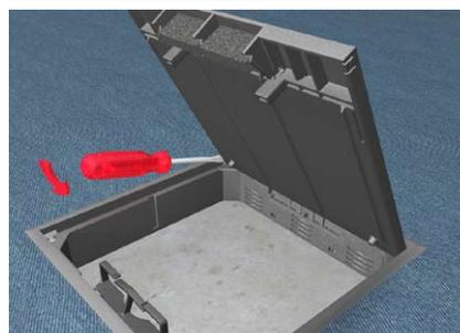
Bei quadratischem Deckel Rastnase des Deckels mit einem Schraubenzieher und einer Drehbewegung lösen.
