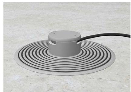
Deckel der Versorgungseinheit sorgfältig schließen. Tubus-Abschlussring mit dem Tubusdeckel am Tubus-Leitungsauslass verschrauben. Somit ist die Versorgungseinheit gegen Schwallwasser (gemäß DIN VDE 0634) von 30 mm geschützt.
