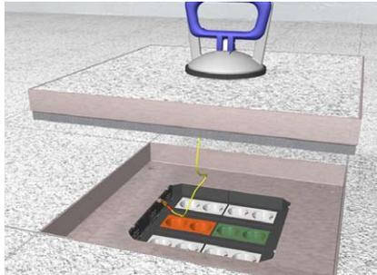
Kassettendeckel mit Schutzleiter-Anschlussleitung am Kassettenrahmen verbinden.
