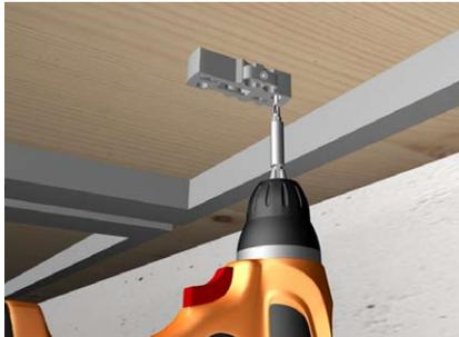
Um die Rundkette unter einem Schreibtisch anzubringen, muss der Anschlussadapter von unten an die Tischplatte befestigt werden.
