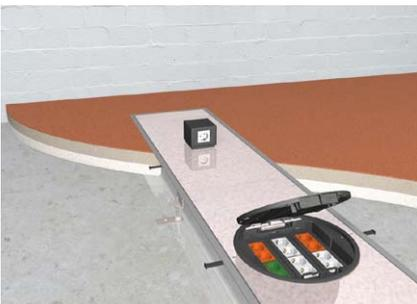
Einbaueinheiten wie z.B. Versorgungseinheiten oder bodenüberragende Zapfsäulen können in den Kanal eingebaut werden. Dazu Blinddeckel gegen Montagedeckel mit entsprechender Öffnung austauschen.
