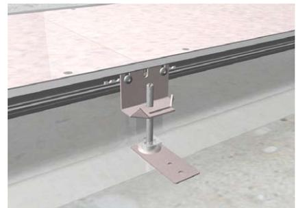
Kanalstücke mit Kanalverbinder, Nivellierschelle und Schrauben M5 miteinander verbinden. Deckelbefestigungsschrauben wieder anziehen. Die flexible Estrichschalung überlappt sich am Kanalstoß.
