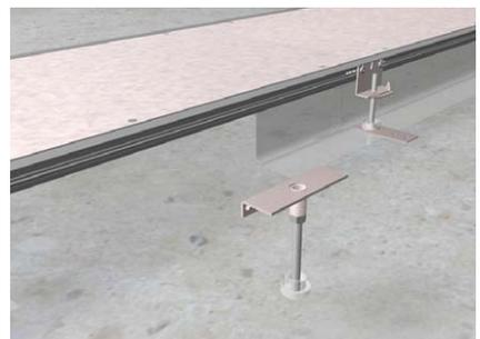
Nivellierstift mit Mutter SM M8 und Dämmleger ZE-D versehen. Nivellierstift in Stützwinkel einschrauben.
