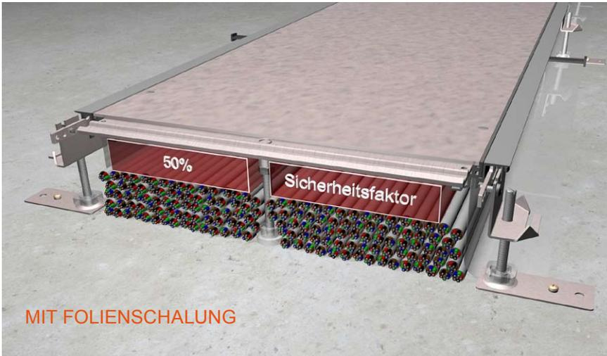
Um die richtige Kanalgröße zu definieren, wird das Kabelvolumen benötigt. Da die Kabel in der Praxis nie optimal parallel und platzsparend nebeneinander liegen, rechnet man hier mit der Formel  $(d)^2$  Durchmesser zum Quadrat.
