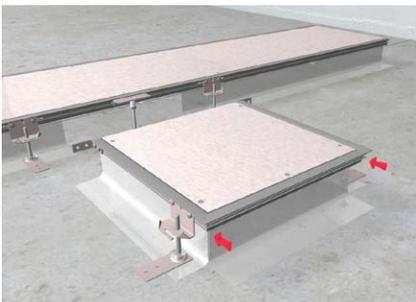
Kanalverbinder in äußere Nut der Anschlussdose setzen. Nivellierschelle am Profil der Anschlussdose mit dem Kanalverbinder verschrauben. Nivellierstift NS M8... in Nivellierschelle einschrauben. Haltepratze mit Dämmleger ZES-HD montieren.
