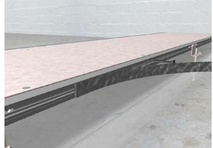
Estrich kann während des Aushärtens Ausdehnungsbewegungen machen, die gegen den Kanal drücken. Diese Druckkraft wird durch die Größe der Estrichplatte und deren Zusammensetzung bestimmt. Der Moosgummistreifen kann am Profil angebracht werden, um diese Druckkräfte zu verringern. Bitte mit dem Estrichleger abstimmen.
