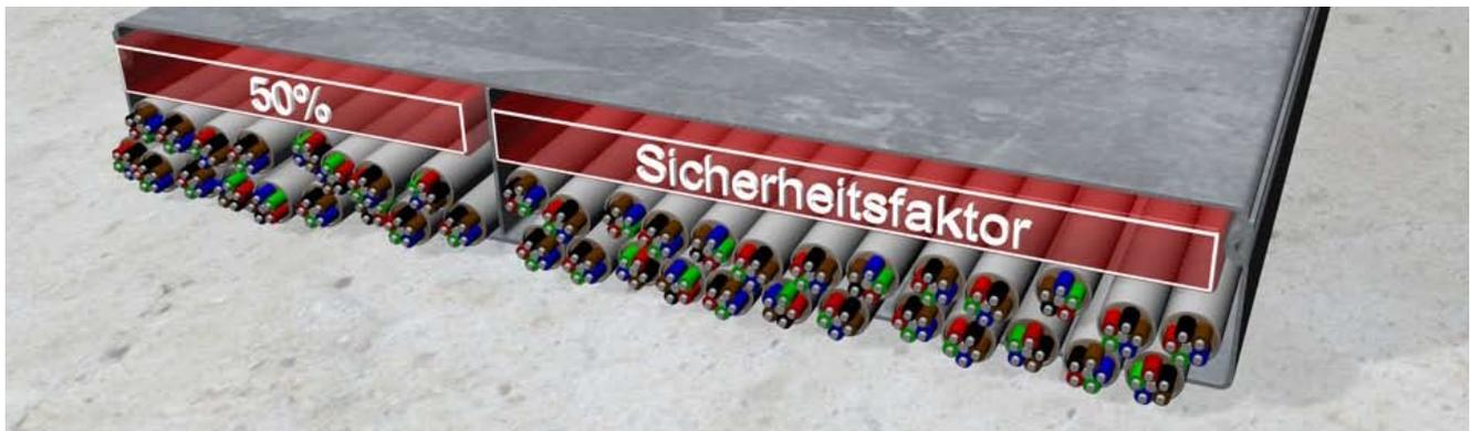
Um die richtige Kanalgröße zu definieren, wird das Kabelvolumen benötigt. Da die Kabel in der Praxis nie optimal parallel und platz sparend nebeneinander liegen, rechnet man hier mit der Formel  $(d)^2$  Durchmesser zum Quadrat.
