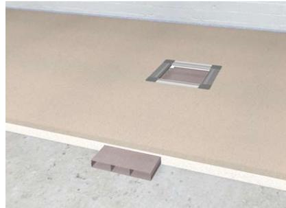
Der Zementestrich wird auf einer Dämmlage verlegt. Die Unterflurkanäle werden in diese Dämmlage eingebunden.
