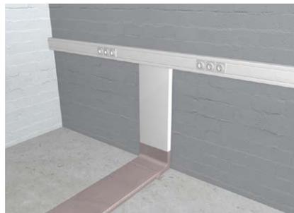
Für eine weitere Kabelführung kann auf den Krümmer ein Einspeisekanal BKE montiert werden. Dieser ist für die Verbindung von Unterflurkanal mit Brüstungskanal vorgesehen.
