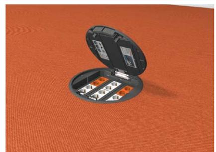
Nach Verlegung des Bodenbelages diesen gemäß der Öffnung des eingebauten Montage- deckel ausschneiden und Versorgungseinheit oder Kassette einbauen.
