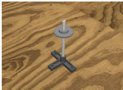
Nivellierstift M8 mit Standfuß und Rändelmutter versehen. Dazu Nivellierstift M8 mit Kunststoffhammer in Standfuß einschlagen. Rändelmutter ca. 15 mm auf den Nivellierstift schrauben.
