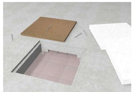
Styroporkörper aus der Rohdecke entfernen. Notfalls Styroporkörper zerstören.
