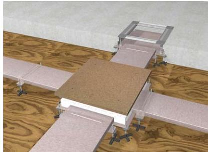
Auf der Rohdecke wird kein Estrich verlegt. Der Inbetondosenrahmen schließt bündig mit der Rohdecke ab.
