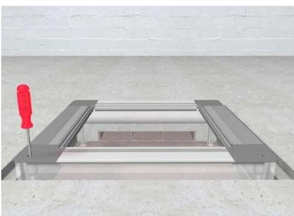
Oberkante des Dosenrahmens auf Oberkante Estrich bzw. Rohdecke ausnivellieren. Dazu Nivellierstifte in den Ecken des Dosenrahmens mit Schlitzschraubendreher drehen.
