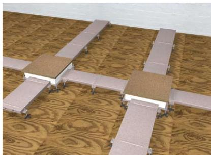
Kanalstücke nach Verlegeplan auf der Schalung auslegen. Am Stoß Kanalstücke mit einer Schelle verbinden. Kanalschellen werden wie das Bodenblech der Bodendose auf der Schalung aufgeständert, angenagelt und nivelliert.
